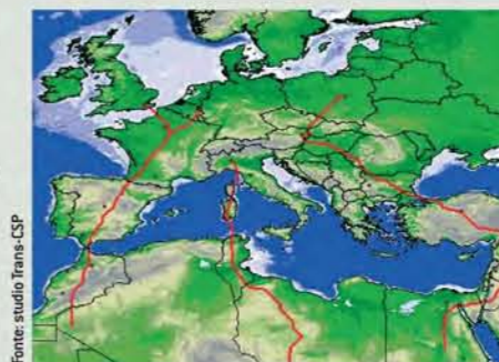
▲ Esempio di tre linee ad altissima tensione in grado di inviare verso l'Europa 105 terawattora all'anno.
